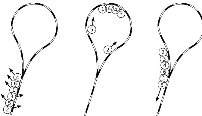
Состав сортируется следующим образом. Сперва он подгоняется хвостом к развязке, после чего последний вагон отцепляется и заводится в тупик. Все остальные вагоны по очереди отцепляют и заводят в тупик по одному из двух путей, присоединяя его либо к голове, либо к хвосту формируемого в тупике состава. Когда все вагоны заведены в «ракетку», сформированный состав целиком выводят оттуда головой вперёд.
